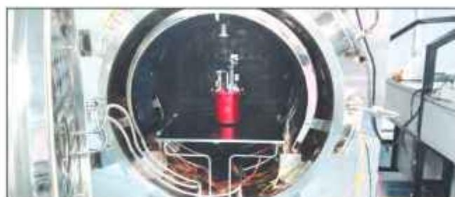
मॉड्यूलर वाटर मिस्ट अप्लिशामक यंत्र के योग्यता परीक्षण के भाग के रूप में, परीक्षण इकाई पर पर्यावरणीय परीक्षण किए गए। इन परीक्षणों में आर्द्रता, साइन और यादृच्छिक कंपन परीक्षण, त्वरण, यांत्रिक आधात और थर्मो-वैक्यूम साइकलिंग परीक्षण शामिल थे। इसके बाद, पूरी इकाई मेसर्स सीज़फ़ायर को सौंप दी गई।
