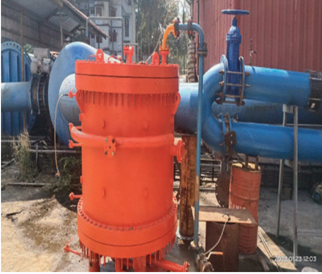
रिसाव दर परीक्षण के लिए परीक्षण सेटअप
