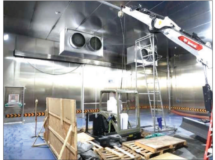
फटीग लैब में निर्माण उपकरण की आपतित वस्तु सुरक्षात्मक संरचना प्रदर्शन परीक्षण
