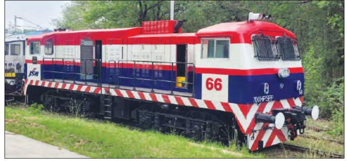
बीएचईएल, झांसी में स्वदेशी रूप से पहली बार डुअल कैब डीजल इलेक्ट्रिक लोकोमोटिव (700 एचपी रेटिंग) को डिजाइन और निर्माण किया गया
