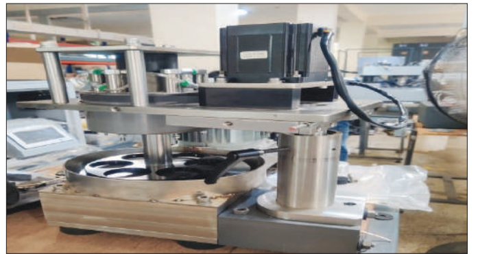
एएमटीडीसी, आईआईटी मद्रास के उत्कृष्टता केंद्र द्वारा विकसित फोटोनिक घटकों के लिए उच्च परिशुद्धता ऑप्टिकल पॉलिशिंग मशीन
