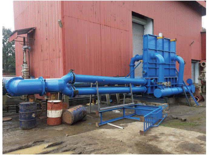
निवल सब-असेंबली के स्लैब मॉडल के हाइड्रोलिक निष्पादन के मूल्यांकन के लिए टेस्ट सेटअप
