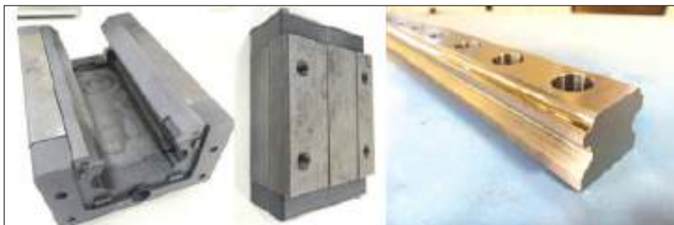
ऑपरेशन रफ मशीन एलएम गाइड ब्लॉक (रीसर्कुलेशन एंडकैप के साथ) और रेल
