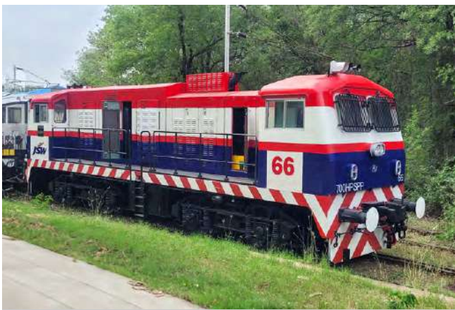
बीएचईएल, झांसी में स्वदेशी रूप से पहली बार डिजाइन और निर्मित डुअल कैब डीजल इलेक्ट्रिक लोकोमोटिव (700 एचपी रेटिंग)
