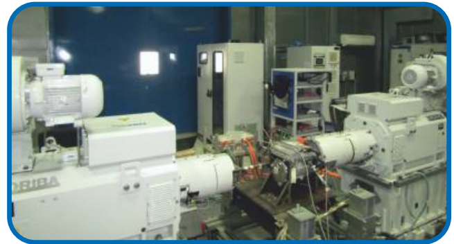
वाहन घटकों के परीक्षण हेतु मशीन-इन-लूप सेट अप
