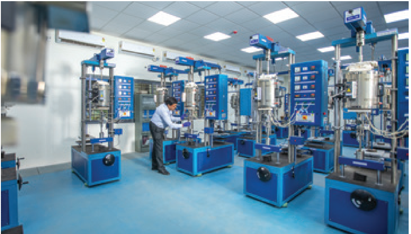
कॉर्पोरेट आर एंड डी, हैदराबाद में धातुकर्म विभाग में उन्नत सामग्रियों की क्रीप परीक्षण सुविधा
