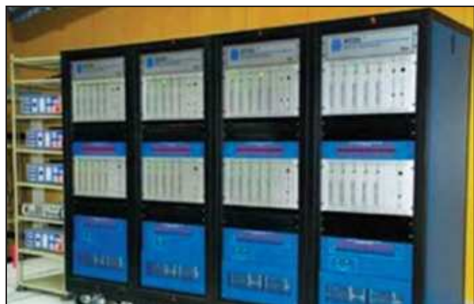
सीआई-एटीएस पर कार्पोरेट अनुसंधान और विकास के तहत स्थापित रीयल टाइम डिजिटल सिमुलेशन सुविधा
