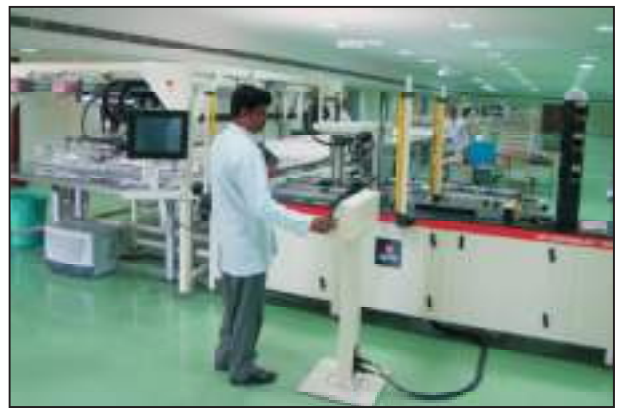
12 मेगावाट की एसपीएल ऑटोमैटिक मॉड्यूल्स लाइन आरआईआईएल
