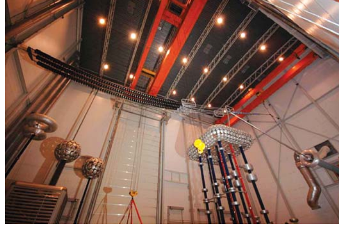
विश्व में पहली बार बीएचईएल ने \pm 800 केवी एचवीडीसी ट्रांसमिशन लाइनों के लिए 320 केएन एवं 420 केएन डिस्क इंसुलेटर्स को सफलतापूर्वक विकसित एवं जांच की है
