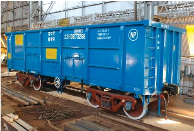
बी एण्ड आर - हावड़ा कार्यशाला में स्टेनलैस स्टील रेलवे वैगन का निर्माण
