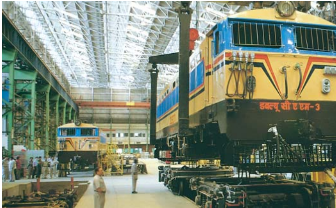
बीएचईएल, झांसी प्लांट में लोको का फेब्रिकेशन एवं असेम्बली
