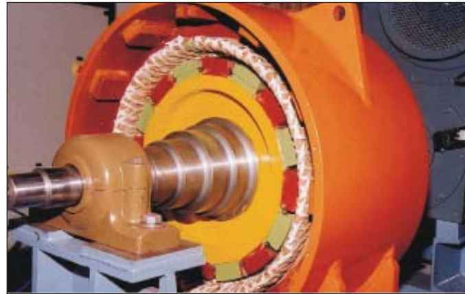
भेल में आंतरिक रूप से विकसित 250 मे.वा. टीजी के लिए पॉयलट एक्साइटर के रूप में उपयुक्त 38 किलोवाट, 220 वोल्ट 400 हार्ट्स कपैक्ट स्थायी मैग्नेट जनरेटर ( पीएमजी )
