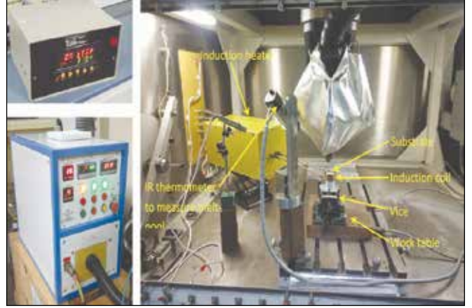
डीएमडी मशीन में बंद लूप तापमान नियंत्रण के साथ इंडक्शन-आधारित सबस्ट्रेट प्रीहीटर
