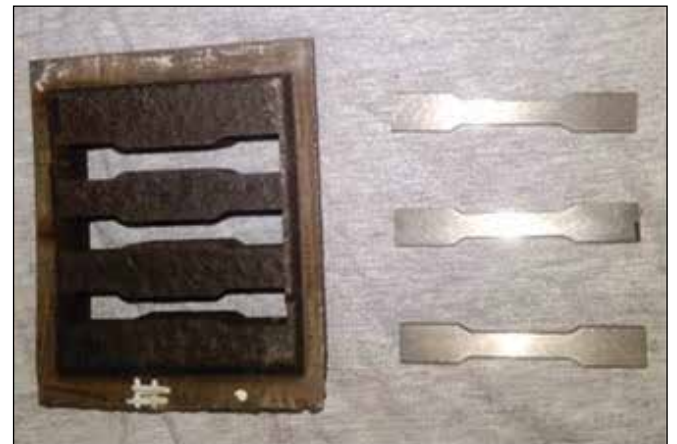
डीएमडी प्रक्रिया द्वारा 15-5 पीएच स्टेनलेस स्टील के टेंसिल परीक्षण नमूने
