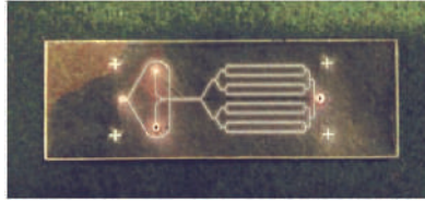
बोरोसिलेट टॉप प्लेट की मशीनिंग Machined Borosilicate Top Plate
