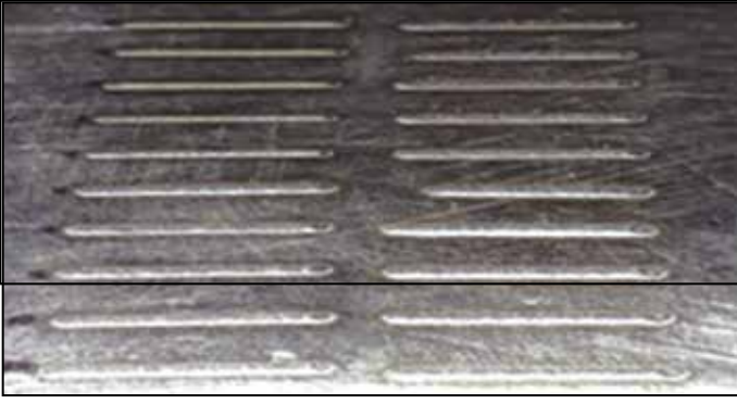
डीएमडी प्रक्रिया के माध्यम से 15-5 पीएच स्टेनलेस स्टील का सिंगल ट्रेक डिपॉजिसन
