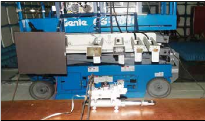
EMI/EMC Test RS03 of LES Actuator
