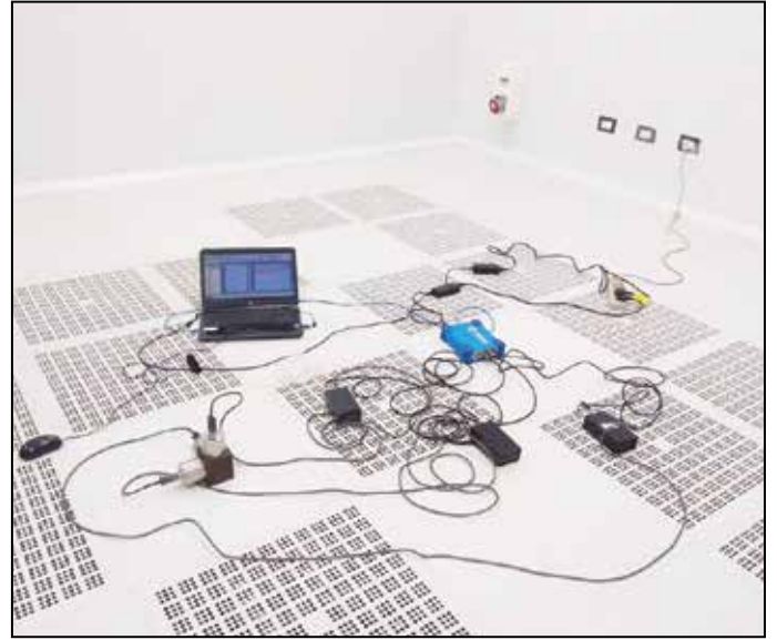
न्यूमिक कंपन आइसोलेटर का कंपन आइसोलेशन प्रदर्शन मापन
