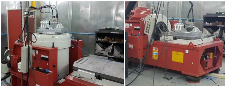
कंपन परीक्षण के दौरान लीसा क्यूल मॉडल
